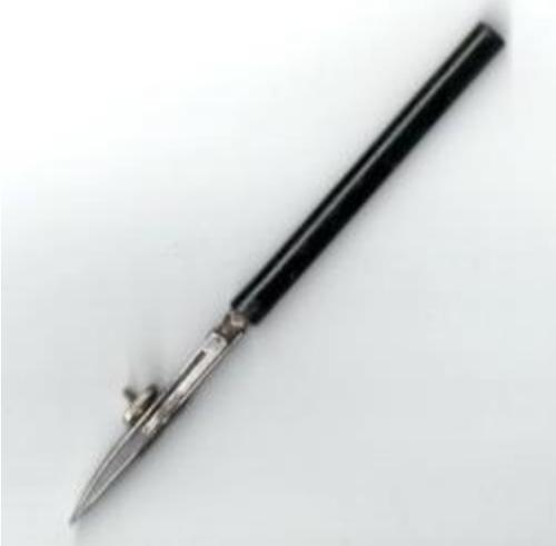
–COMPÁS DE PUNTAS.Este instrumento de marcar tiene una función semejante al de cualquier compás de dibujo,la diferencia consiste en que al se utilizado para dibujar sobre materiales diferentes al papel no tiene la punta de gráfito que se requiere para este propósito.En vez de la punta de gráfito, las puntas estén afiladas terminando en punta,para marcar en la pieza que estés usando y poder elaborar el dibujo.
