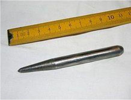
–PUNTAS DE MARCAR. Se utiliza para marcar líneas de referencias, tales como ejes de simetría, centros de taladros, o excesos de material en las piezas que hay que mecanizar, porque deja una huella imborrable, durante el proceso de mecanizado, una especie de lápiz capaz de rayar metales.
