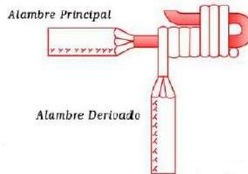
Es otro tipo de derivación sencilla. Se utiliza cuando al final de la línea necesitamos hacer una última derivación. Esta unión realiza un buen contacto eléctrico y presenta bastante resistencia a la tensión mecánica, también es muy utilizado cuando el cable derivado es más delgado que el principal.
