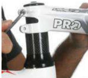
Debemos apretarlos alternativamente. La unión entre la abrazadera y la potencia debe cerrar de manera uniforme y no estar más junta en un lado que en otro. Podemos hacerlo con una llave allen normal, pero es conveniente utilizar una dinamométrica si el manillar es de carbono para no llegar a romperlo.
