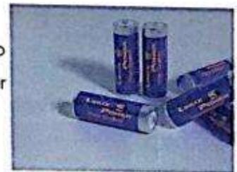
**Secundarias o recargables:** tienen la posibilidad de volver a cargar sus sistemas cuantas veces sea requerido, se diferencian por poseer algún detalle en color verde para su rápida identificación. Se usan en gran medida por los fotógrafos.
